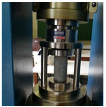
prova e se realiza o ensaio de compressão, conforme esquema da Figura 3. Os resultados podem ser obtidos pelas equações 2(resistência a tração na flexão) e 3 (resistência a compressão).
