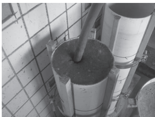
Figura 8 – Vibração da argamassa do corpo de prova
