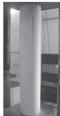
Figura 11 – Fissuras apresentadas pelo corpo de prova “branco” no ensaio à compressão axial
