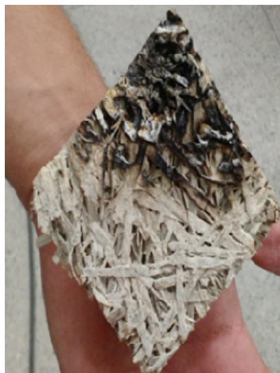
Figura 6: Compósito exposto a temperatura de 200 C° por 5 minutos.
