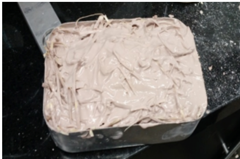
Figura 3: compósito formado pela junção da madeira e do cimento sorel.
