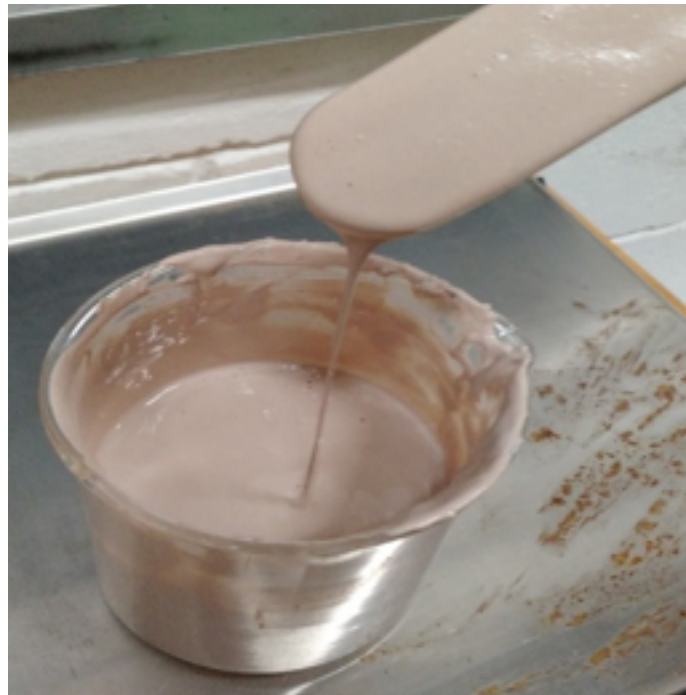
Figura 2: Cimento sorel dissolvido em Solução de cloreto de magnésio.
