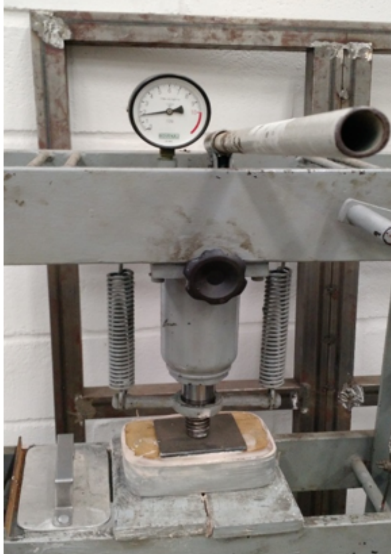
Figura 4: Prensagem da amostra em uma prensa hidráulica.
