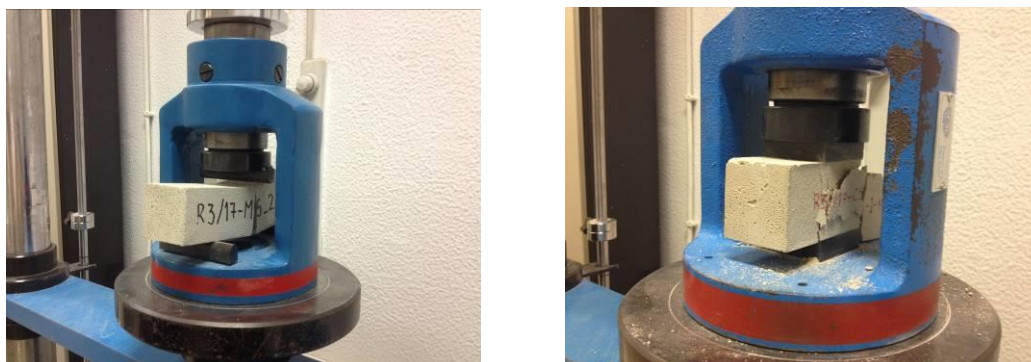
Figura 4: Ensaio para determinação da resistência das argamassas: (esquerda) à flexão e (direita) à compressão
