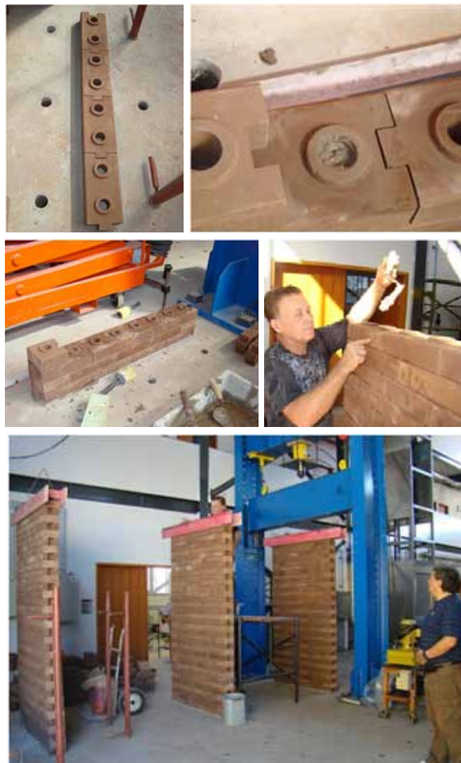
Figura 3 – Vista geral da execução das paredes.
