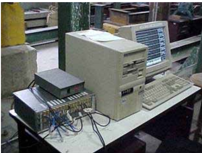
Figura 9 – Vista do Sistema de Aquisição de Dados (SAD).
