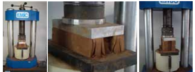
Figura 10 – Detalhes dos ensaios em um tijolo e em um prisma.
