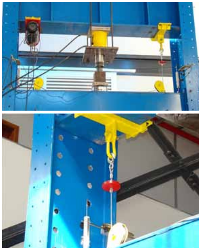
Figura 7 – Detalhe do ensaio de parede: transdutor de deslocamento utilizado para determinação do deslocamento vertical.
