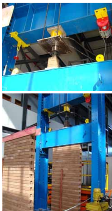
Figura 5 – Vista do pórtico de reação, do sistema de aplicação de carga e atuador.
