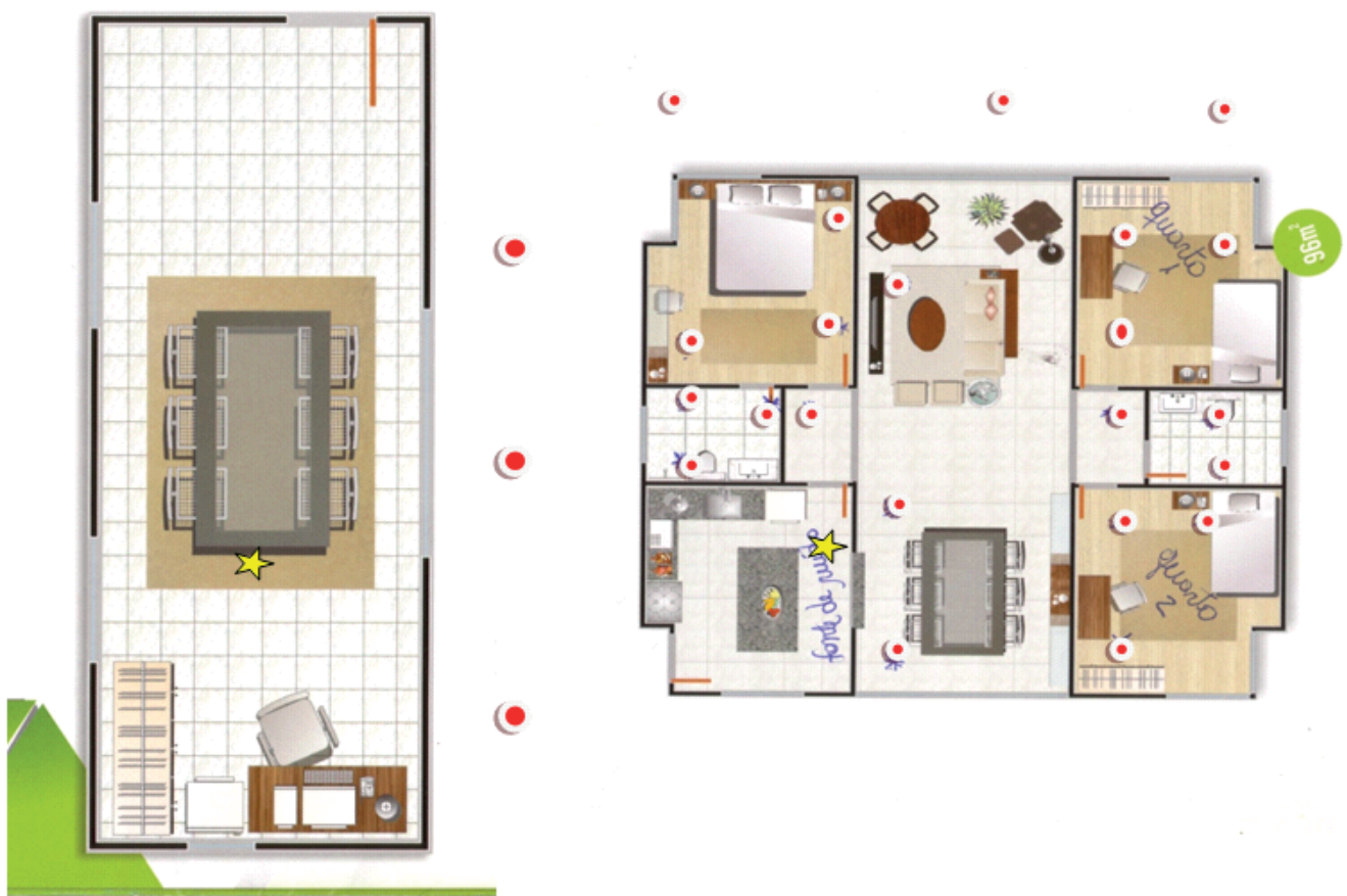
Figura 6 – Desenho esquemático dos pontos de medição
