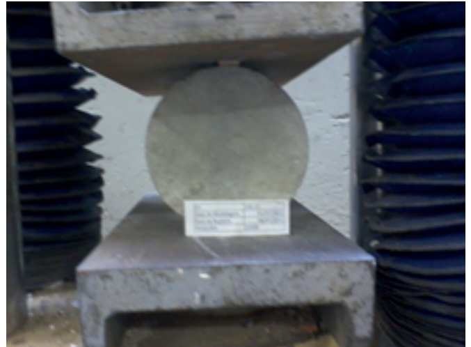
Figura 2 – Corpo de prova submetido ao ensaio de compressão diametral.
