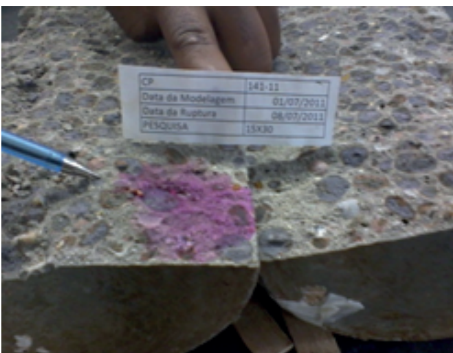
Figura 2 – Corpo de prova submetido ao ensaio de compressão diametral.
