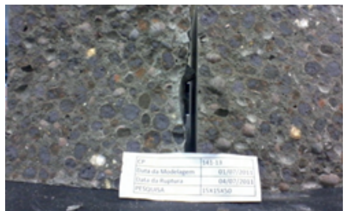
Figura 3 – Corpo de prova submetido ao ensaio de flexão.
