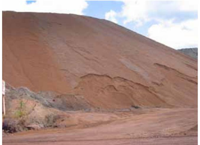
Figura 1- Pilha de estoque de rejeito de sinter feed em área de mineradora
