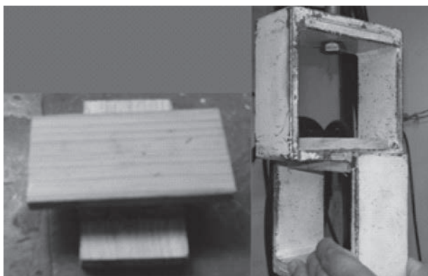
Figura 1: Ensaio de resistência à tração perpendicular
