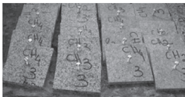
Figura 2: CP's para ensaio de arrancamento de parafuso na superfície
