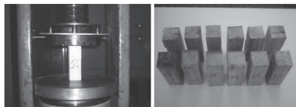
a) Ensaio de compressão | b) Corpos de prova de MLC após ensaio
