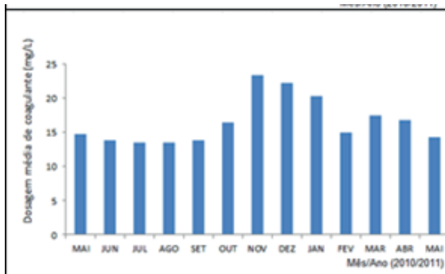
Figura 3 – Turbidez afluyente à ETA em estudo e dosagens de coagulante: dados médios registrados no período entre as duas últimas lavagens dos decantadores. Fonte: Ferreira, B. O; Vianna, M.R., 2011
