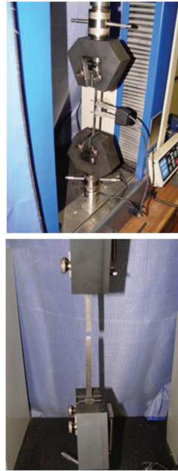
Figura 8 – (a) Corpo de prova de tração de aço, (b) Início do ensaio à tração do corpo-de-prova de aço. (c) Término do ensaio de tração mostrando o CP rompido.
