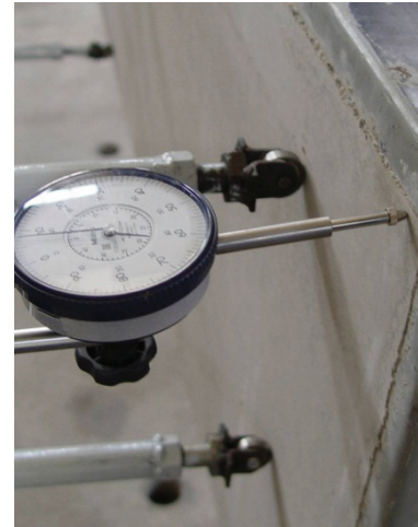
Figura 6 – Sistema de contraventamentos e relógios comparadores para monitoramento de deslocamentos laterais da viga.
