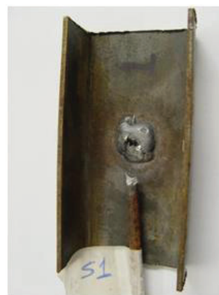
Figura 11 – (a) Detalhes do CP para determinação da resistência à tração na ligação soldada da barra de aço ao perfil U. (b) Montagem do ensaio de tração na ligação soldada. (c) Ruptura típica da ligação da ligação soldada.
