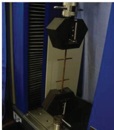
Figura 9 – (a) Corpo-de-prova extraído da tela Q113 para ensaio de tração. (b) Ensaio à tração em CP da tela Q113
