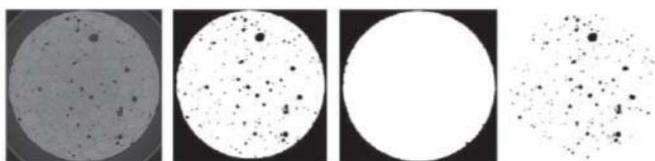
Figura 1 – Amostra de concreto em condições normais, após a impregnação com contraste e tratamento da imagem
