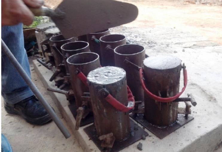
**Figura 1** – Confeção dos corpos de prova
