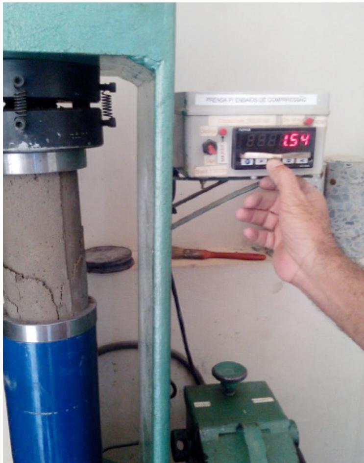
**Figura 2** – Rompimento do corpo de prova
