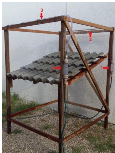
Figura 13: Estrutura para determinação do Ensaio de Impermeabilidade, composta por: 1 - Medidores de Vazão, 2 - Cano de aspersão, 3 - Bicos pulverizadores.
