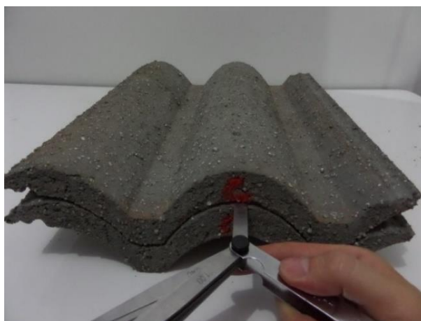
Figura 7: Determinação do “GAP” entre duas telhas sobrepostas.
