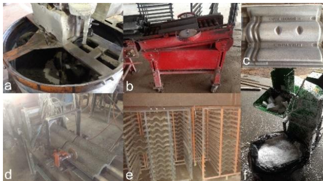
Figura 3: a) Misturador; b) Desmoldador; c) Molde; d) Máquina Extrusora; e) Estantes Secadoras e Câmara de Cura; f) Triturador.
