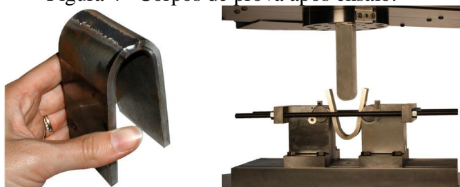
Figura 4– Corpos de prova após ensaio.
