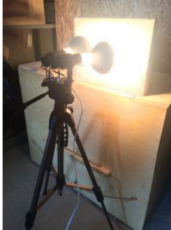
Figura 4. Fonte de calor de 500 W durante aquecimento de CP
