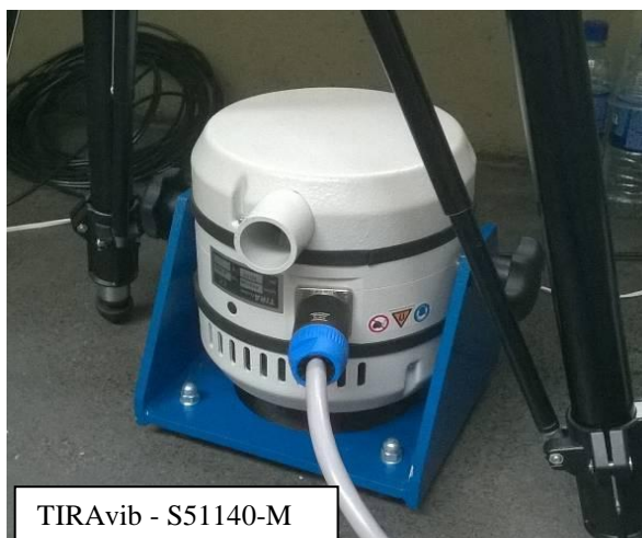
Figura 10: Ensaio 3: shaker (TIRAvib – S 51140-M) e amplificador de potência BAA 1000.
