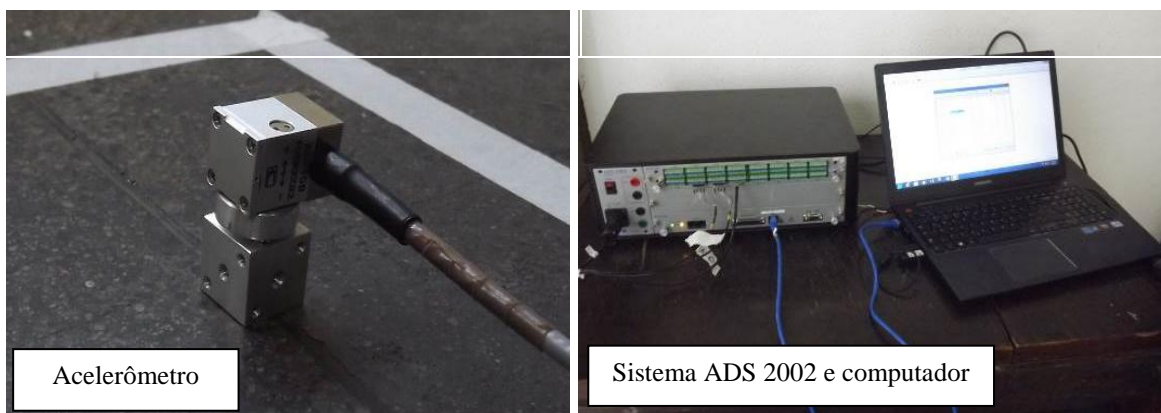
Figura 7: Ensaio 1: sistema de aquisição ADS 2002 conectado a acelerômetros.
