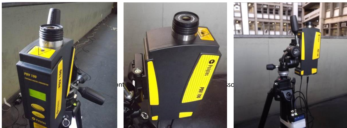
Figura 8: Ensaio 2: vibrômetro a laser Polytec (Portable Digital Vibrometer: PDV-100).
