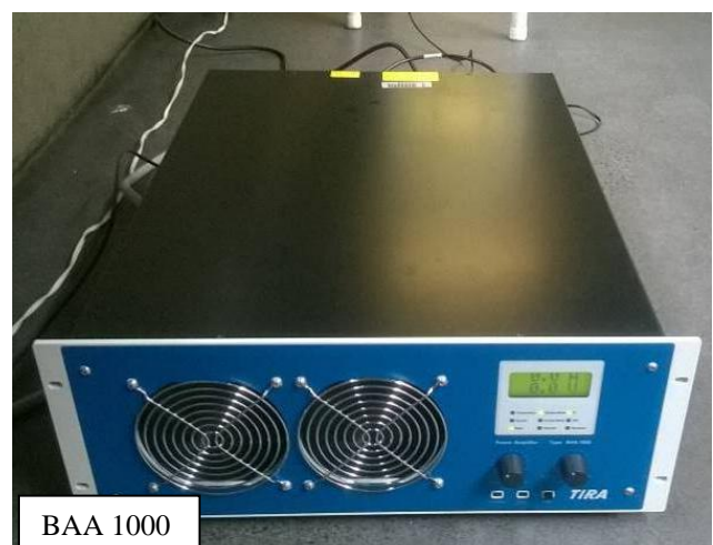
Figura 10: Ensaio 3: shaker (TIRAvib – S 51140-M) e amplificador de potência BAA 1000.
