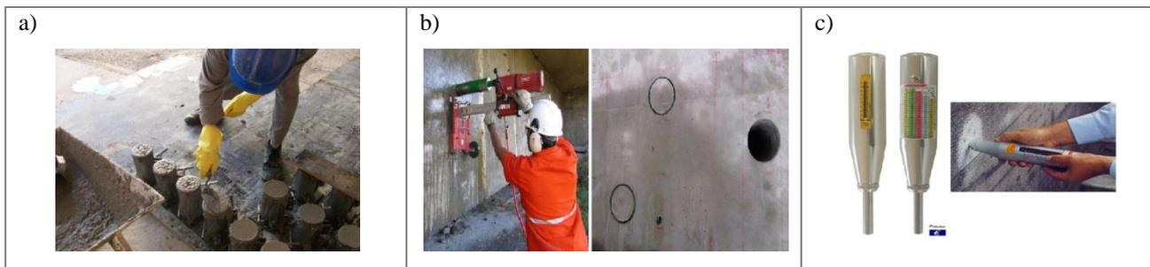
Figura 1 - Métodos de avaliação da resistência à compressão do concreto.
