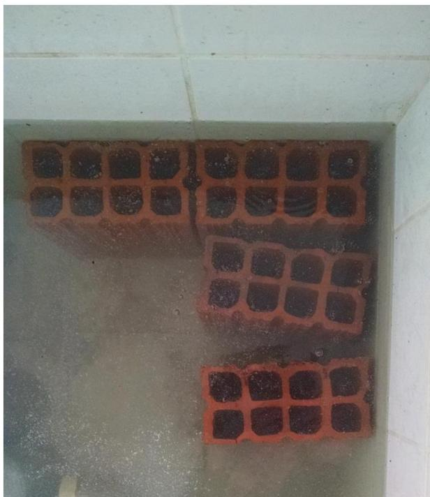
**Figura 1. Tanque de água com as amostras submersa**
