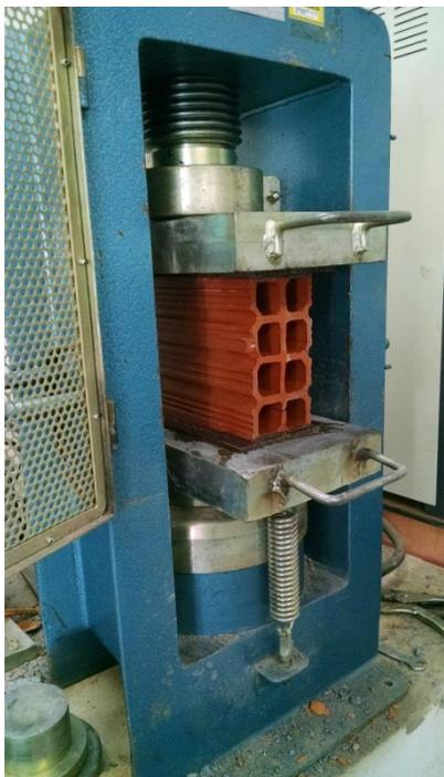
**Figura 2. Prensa para teste de compressão**
