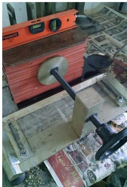
**Figura 3. Capecamento do Bloco cerâmico**
