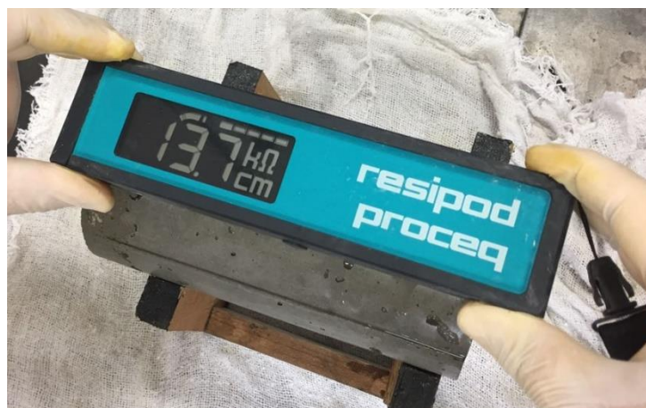
Figura 2 - Medição da Resistência Elétrica de Quatro Pontos
