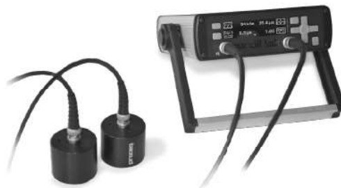
Figura 5 - Exemplo de equipamento utilizado no ensaio de ultrassom
