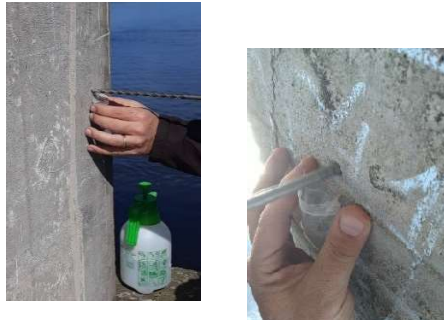
Figura 23 - Extração de amostras para ensaio
