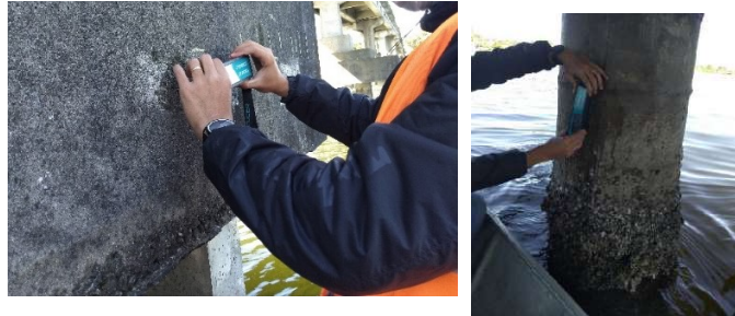
Figura 19- Ensaios de resistividade elétrica nas estruturas da OAE
