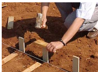
Figura 3: Colocação dos corpos-de-prova no campo de experimentação.
