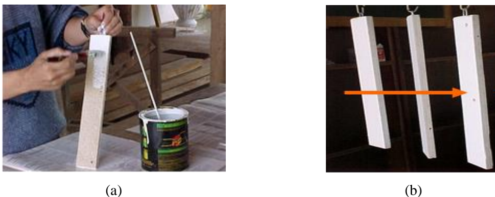
Figura 1: Tratamento (a) e secagem (b) dos corpos-de-prova.
